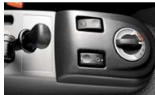
El cuadro de mandos de la AS-Tronic está situado en la consola junto al asiento del conductor.
